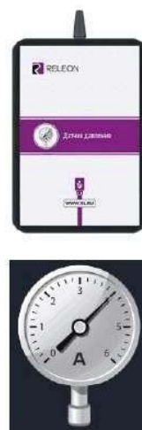
Рис. 2. Датчик абсолютного давления
