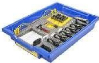
Рис. 7. Комплект сопутствующих элементов для экспериментов по оптике
